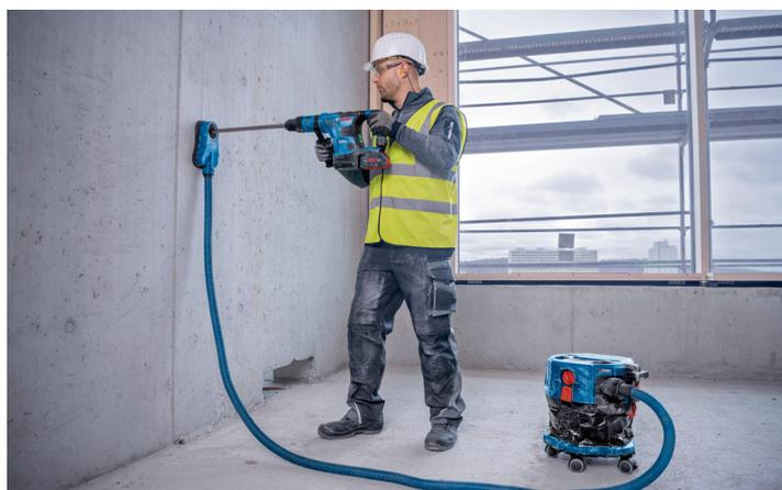
Si le débit tombe en dessous de 20 l par seconde, en raison d'une obstruction du filtre, le système de contrôle du débit volumétrique intégré avertit l'utilisateur par un signal sonore et visuel.
