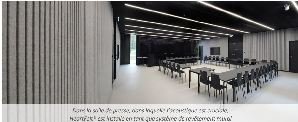
*Dans la salle de presse, dans laquelle l'acoustique est cruciale, HeartFelt® est installé en tant que système de revêtement mural*
