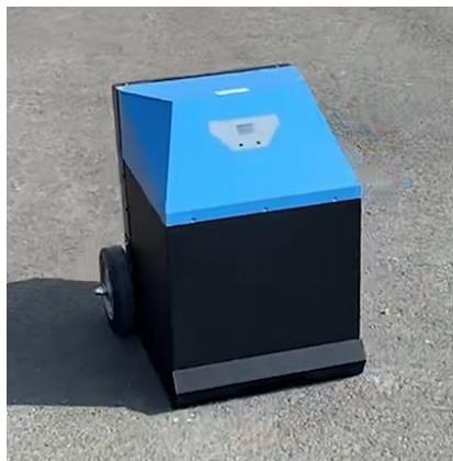
**Innovation :** Le SKEED-3D, l'innovation pour sécuriser les routes avec une mesure automatique de l'adhérence. L'adhérence des chaussées neuves, valeur clé pour garantir la sécurité routière, est caractérisée par « l'essai à la tâche » ; très manuel. Ce protocole éprouvant physiquement expose fortement les opérateurs, sans offrir une mesure 100% fiable.
