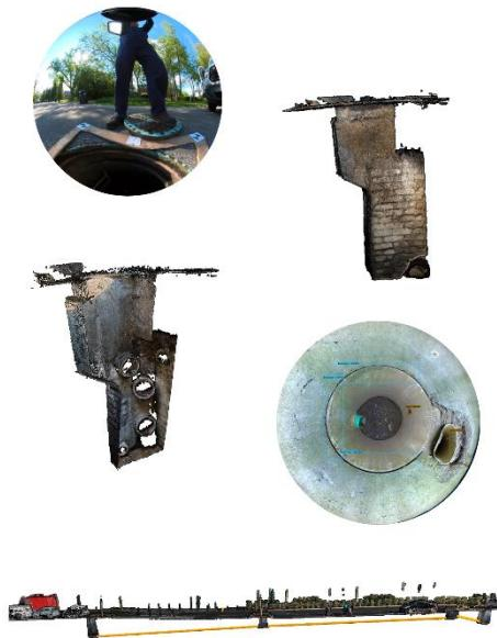
**Application :** IGNAR se veut un outil d'aide à la décision pour l'entretien des regards des réseaux d'écoulement, pour tous les exploitants d'usage. Cet outil peut intégrer différente dimension technologique, du référencement SIG et BIM, au développement de jumeau numérique, en passant par l'intégration de réalité augmenté et d'IA faisant de cette technologie un outil efficace d'aide à la décision
