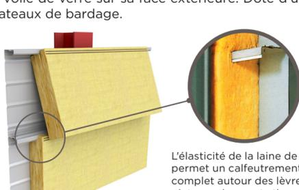
L'élasticité de la laine de verre permet un calfeutrement complet autour des lèvres des plateaux, les ponts thermiques sont réduits au maximum.
