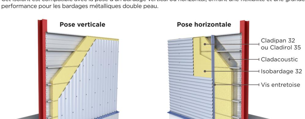
Les plateaux peuvent être fixés sur des structures en acier, bois, ou béton. Le système est adapté pour des usines, bâtiments tertiaires, ateliers et centres commerciaux.
