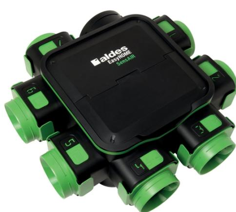
Dans les pièces humides (cuisine, salle de bains, WC), le système détecte directement les polluants et **module pièce par pièce** les débits d'extraction. Dans les pièces sèches (chambres, salons, bureaux), **des capteurs déportés** mesurent en continu la concentration de polluants dans l'air. Lorsqu'un niveau élevé de polluants est détecté, le système augmente automatiquement la ventilation dans les pièces humides, afin d'assurer une évacuation optimale de l'air vicié.
